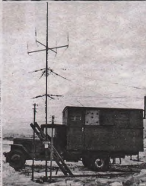
Радиомаяк «Колба» вначале состоял из двух, потом – из четырех машин. Мачта высотой 31,5 метра
